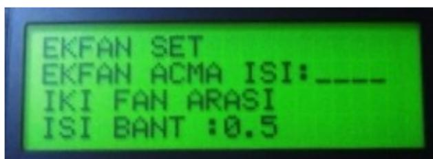
Bu menüden istenen fanlar 0 rakamı girilerek kapatılabilir. 1 rakamı girilerek sürekli açık bırakılabilir. 2 rakamı girilerek Isiya bağlı çalıştırılabilir. Yada 3 rakamı girilecek Zamansal çalıştırılabilir.
